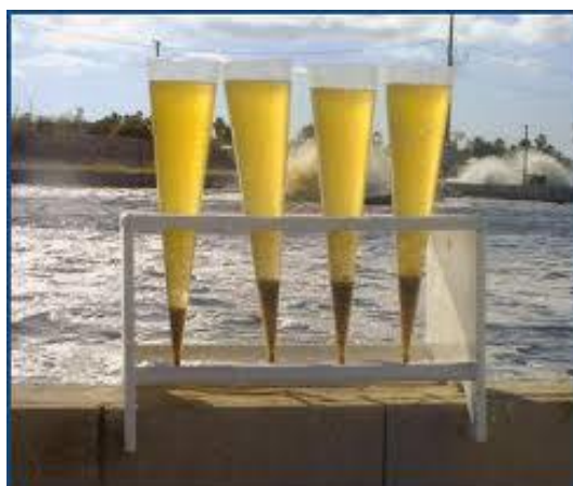
شکل ۲ قیف مدرج مخروطی شکل (Imhoff cone) برای تعیین میزان مواد جامد ته نشین شده آب استخر
